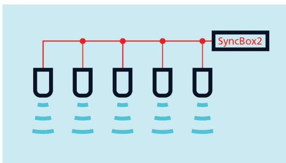
Synchronisation d'un maximum de 50 capteurs zws
