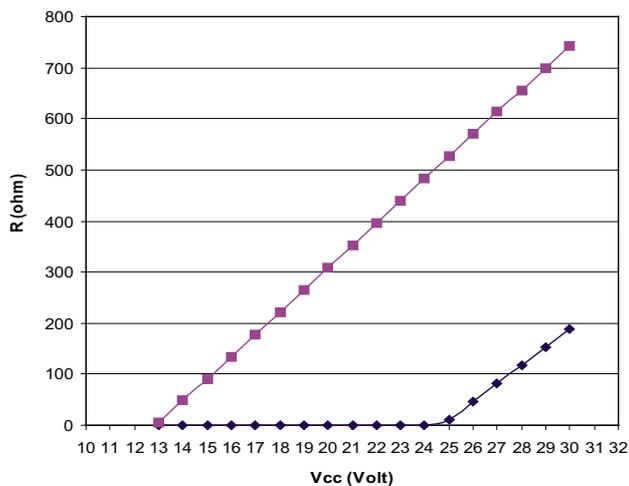
Ce diagramme représente le rapport optimal entre la charge et l'alimentation pour transmetteurs avec sortie 4...20mA. Pour le fonctionnement correct, utiliser une combinaison de résistance de charge et tension d'alimentation en mesure de rester dans la zone en pointillé.
