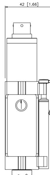
La fonction Autozéro est activée par le biais d'un contact magnétique (aimant extérieur livré avec le capteur). Pour la version externe Autozero court-circuiter la broche correcte. Pour la description complète de la fonction Autozéro, se reporter au manuel opérateur.
