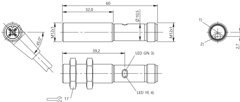
1) Axe optique récepteur, 2) Axe optique émetteur, 3) Tension d'emploi, 4) Réception lumineuse / zone limite
