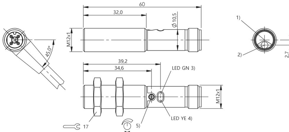
1) Axe optique récepteur, 2) Axe optique émetteur, 3) Tension d'emploi, 4) Réception lumineuse / zone limite, 5) Sn
