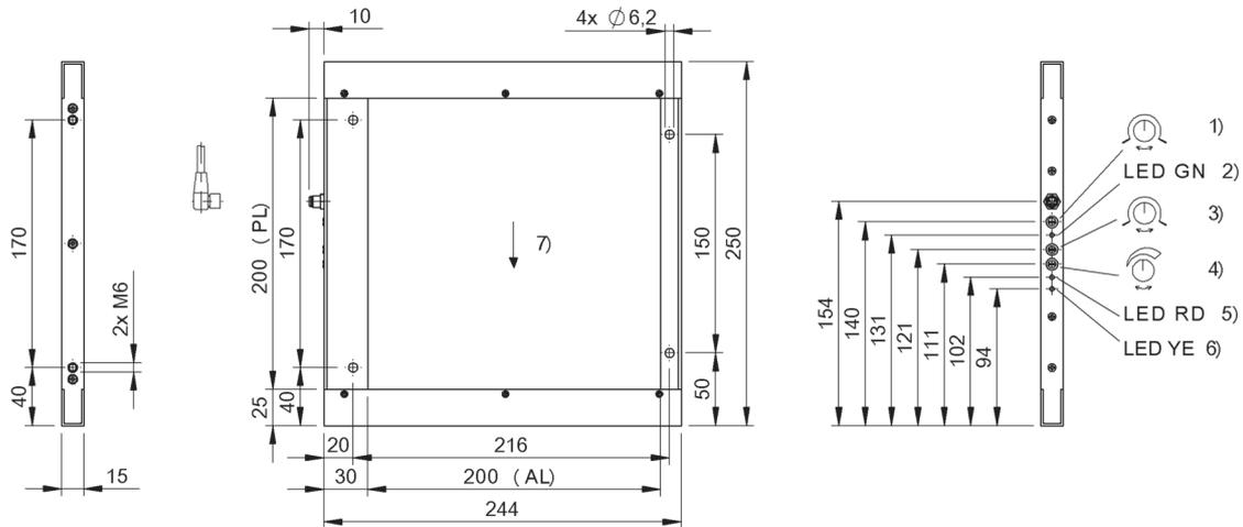
1) Prolongateur d'impulsions, 2) LED affichage de fonctionnement, 3) Fonction de commutation, 4) Résolution de l'objet, 5) LED avertissement, 6) LED de visualisation d'état, 7) Axe optique
