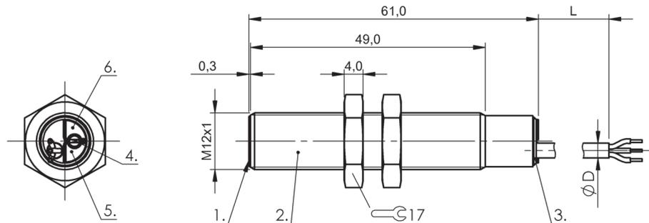
1) Face sensible, 2) Boîtier, 3) Couvercle, 4) Potentiomètre, 5) LED de tension d'emploi, 6) LED de visualisation d'état
